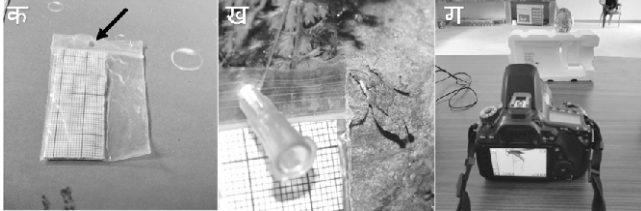
चित्र ६. मिलिमिटर माननाप: क. प्लास्टिक केसमा मिलिमिटर माननाप; ख. प्राकृतिक बासस्थानमा भुइँफड्केको फोटो खिच्ने क्रममा माननापको प्रयोग; ग. माननाप सहित सङ्ग्रहित नमूनाको फोटो लिइँदै।
